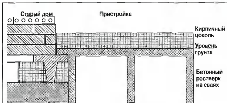
Рис. 9. Схема пристыковки столбчатого фундамента пристройки к имеющемуся фундаменту дома
