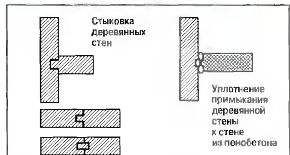
Рис. 10. Стыковка деревянных стен пристройки и дома
